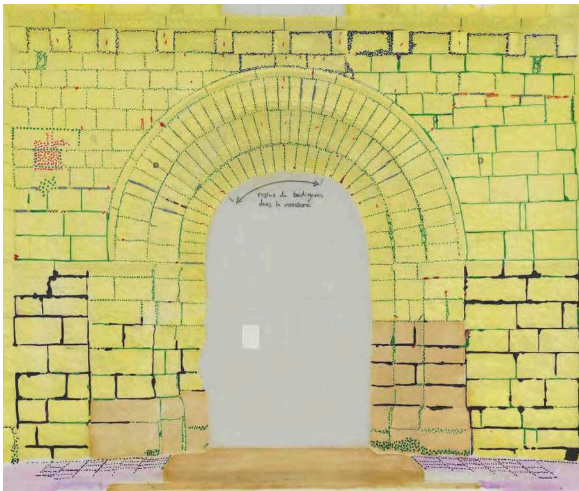
18. ↑ Relevé de constitution du portail ouest. (Dessin O.Rolland sur fond A.de Saint-Jouan, ACMH, photo J.-B. Darrasse).
