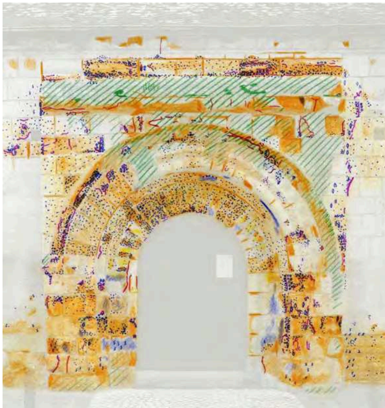
46. ← Relevé des altérations du portail nord. (Même source).
