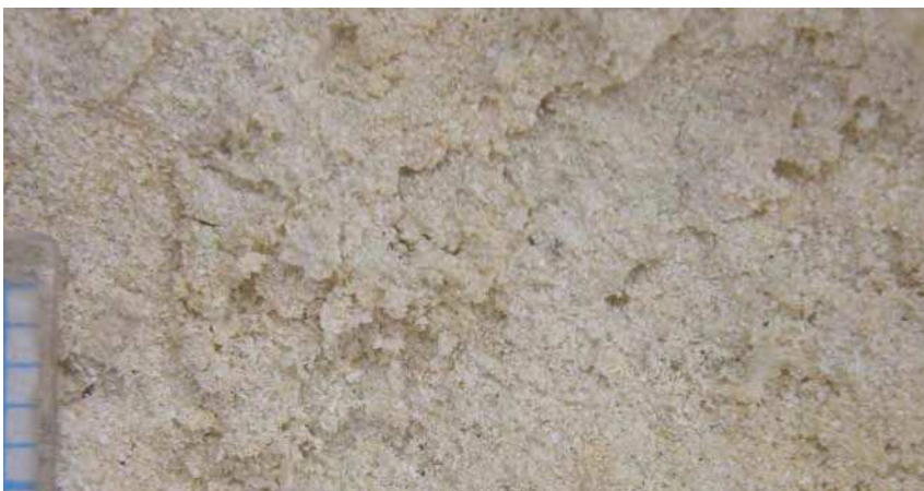
53. ← Détail grossi cinq fois environ du tuffeau sous une feuille de tuffeau détachée pour le prélèvement ERM2 mentionné ci-dessus. On distingue les cristallisations blanches des sels solubles. P4280275
