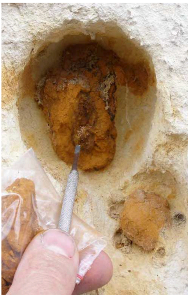
58. ← Façade ouest, 6 ème assise au-dessus de la petite corniche, à gauche du portail. Pyrite altérée ? Emplacement du prélèvement P9 (voir annexe page 47 et suivantes) P4200101
