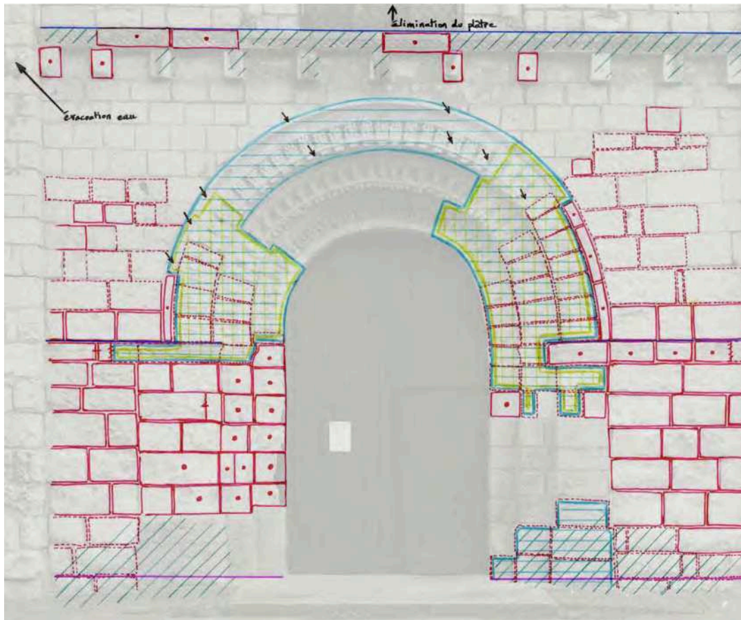
96. ↑ Relevé de traitement proposé pour le portail ouest. (Dessin O.Rolland sur fond A.de Saint-Jouan, ACMH, photo J.-B. Darrasse).
