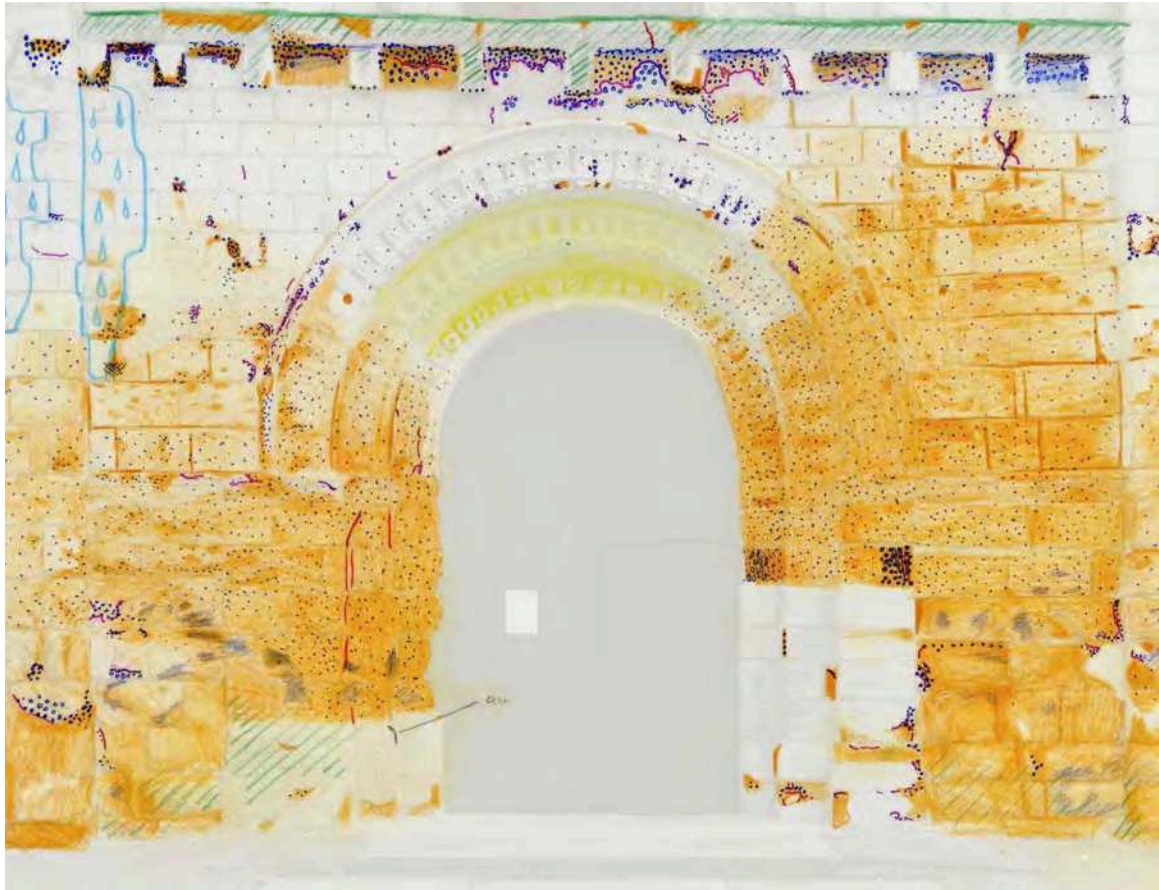
45. ↑ Relevé des altérations du portail ouest. (Dessin O.Rolland sur fond A.de Saint-Jouan, ACMH, photo J.-B. Darrasse).
